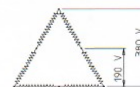
Verlaagd ontdooivermogen (elementen in de aansluitkast ompolen).
